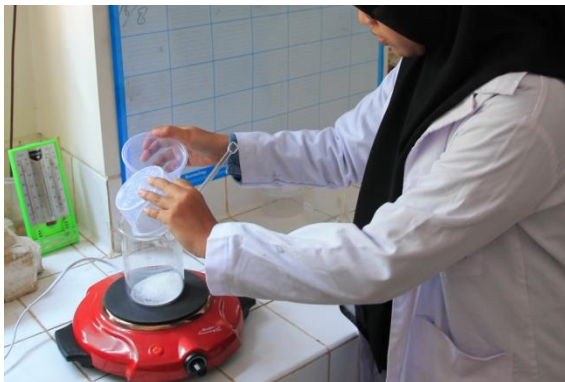
Pembuatan larutan Asam Sitrat memerlukan pemanasan di atas kompor listrik
